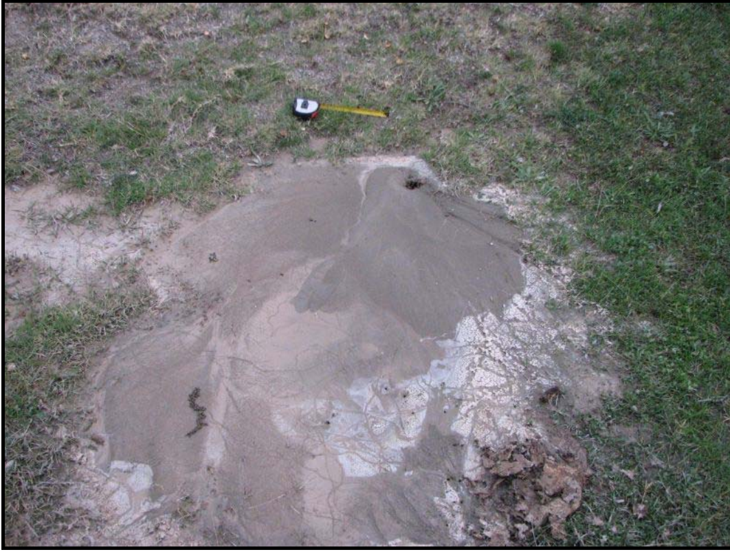
Foto C7. Göllü güneyinde Karasu vadisi tabanında gelişen sivilaşma konileri.
